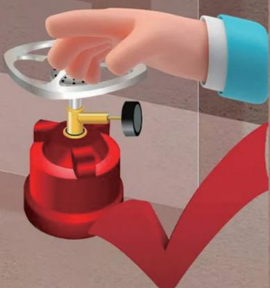
使用完燃气后,应关闭气瓶阀门、管道与软管连接阀门和灶具开关。
